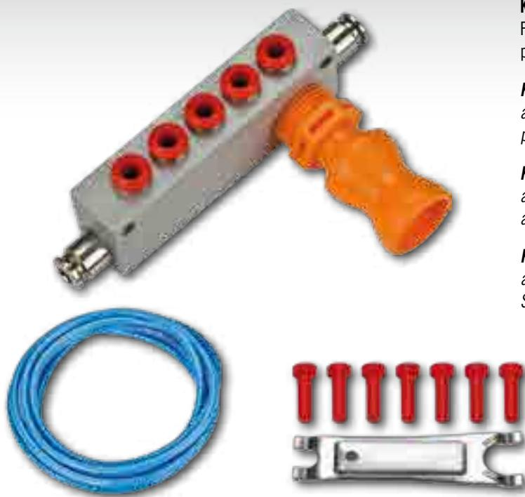
**KIT A7000:** Ripartitore in alluminio a 5+2 vie per applicazione su Torni a Fantina mobile completo di attacco Loc Line 1/2", tappi e 3 metri di tubo in poliuretano Ø 6x4 (Pressione Max consentita 12 Bar).
